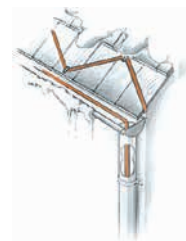
Beheizungen von Dachrinnen und Fallrohren
